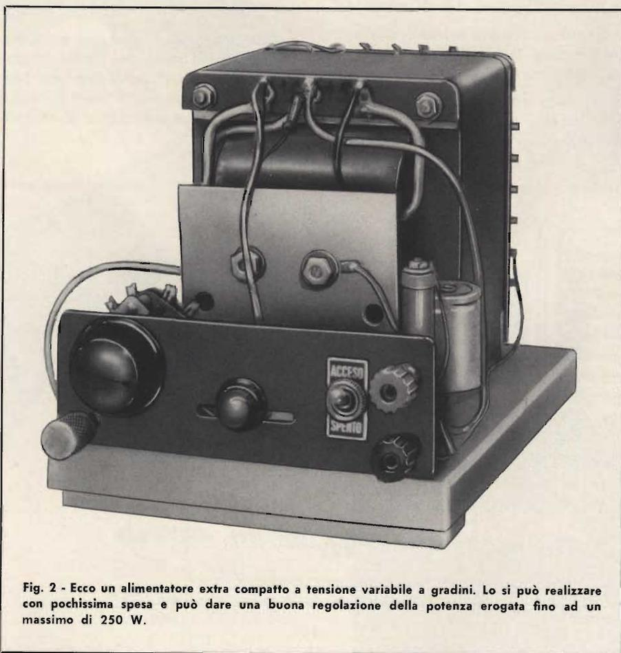
Fig. 2 - Ecco un alimentatore extra compatto a tensione variabile a gradini. Lo si può realizzare con pochissima spesa e può dare una buona regolazione della potenza erogata fino ad un massimo di 250 W.
